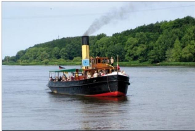
Das ca. 30 x 7,5 m große und knapp 200 t verdrängende Schiff hat einen Tiefgang von 1,60 m. Angetrieben wird es von einem Großwasserraumkessel schottischer Bauart, der um die 500 kg Kohle in der Stunde verbraucht und eine Zweizylinder-Expansions-Dampfmaschine antreibt, die bei 180 Umdrehungen pro Minute 280 PS erzeugt. Die „Elbe“ ist der einzige erhaltene dampfbetriebene Flusseisbrecher einer Flotte von 8 zwi-
